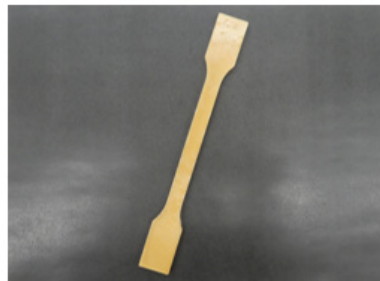
バイオマス度 90%以上 セルロースファイバー成形材料を用いた成形体
