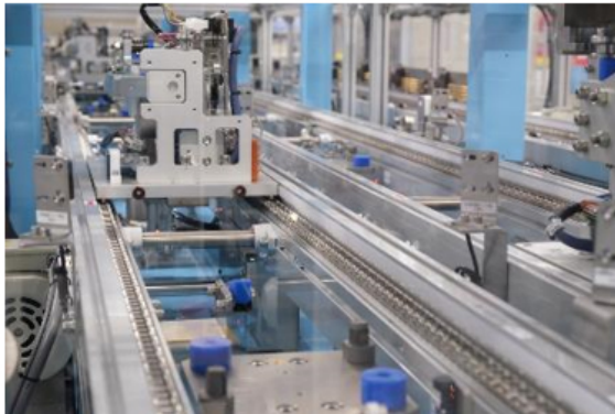
カルパワードライブユニット自動検査設備
