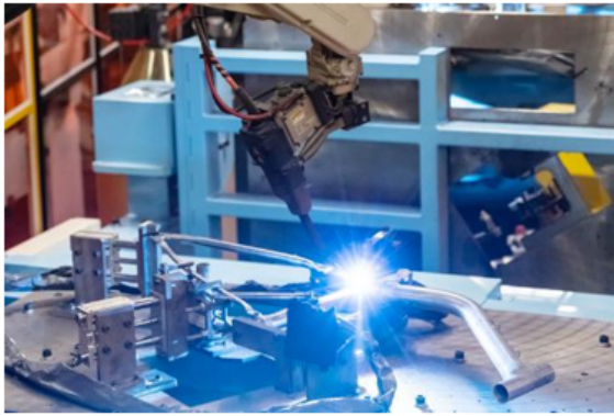
自動溶接ロボット
