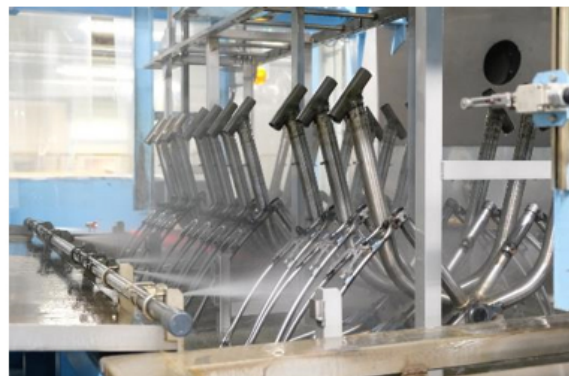
節水型被膜処理設備 スプレー圧洗浄（置換水洗）
