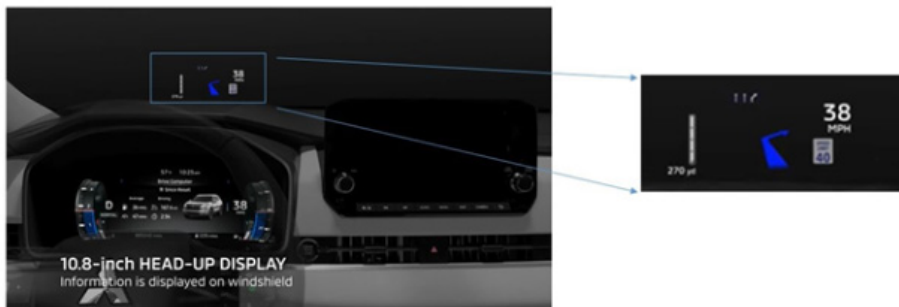
フロントガラスに投影される HUD のイメージ (画像提供: 三菱自動車)
