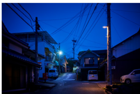
【「星空に優しい照明」(手前)と白色LED防犯灯(奥)】
