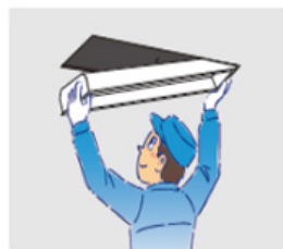
既設の埋込型 ベースライトを 取り外す
