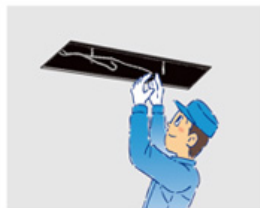
既設器具の 開口と配線を利用
