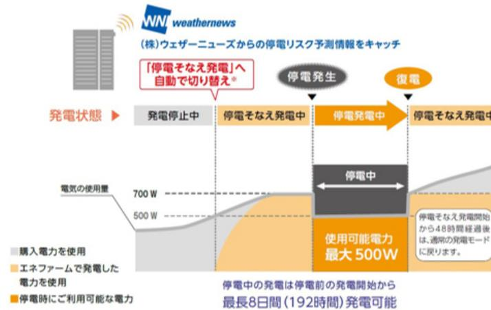
ウェザーニューズは、過去の台風で発生した停電情報と風速データの相関関係の分析を元に開発した独自の予測モデルを用いて、5 km メッシュのエリアごとに停電発生リスクを予測します。この「停電リスク予測」はパナソニックのクラウドサーバーに送られ、そこから対象地域のエネファームに「停電そなえ発電」への切り替え信号を発信します。
