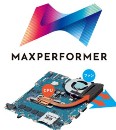
SV9の基板写真。パナソニック独自のファンで、高性能な第10世代CPUを効率よく冷却し、高性能を長時間発揮させられます。
