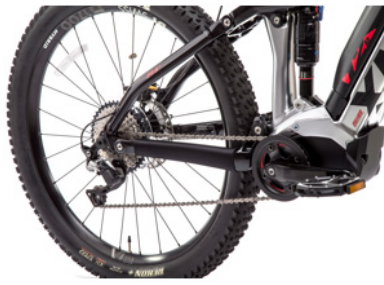
フロント内装2段×リア シマノ製 11段「SLX」を採用
