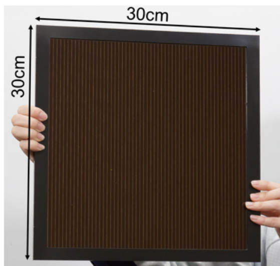
図1 世界最大面積と世界最高変換効率を達成したペロブスカイト太陽電池モジュール
