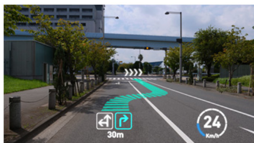
実際の風景と HUD の情報を重ね合わせ、わかりやすく表示する。(イメージ図)
