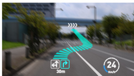
振動補正技術なしの画像。路面の凹凸や加速減速などで車両が振動し、視界に大きなズレが発生する。
