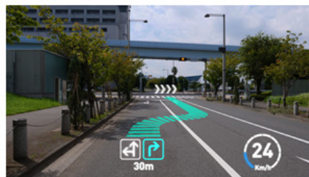
振動補正技術を適用した画像。車両の振動によって生じるズレをデジタル補正し、見やすく表示。
