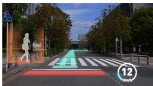
停止線、歩行者等を検知し、強調した表示で、注意を促す。(イメージ図)
