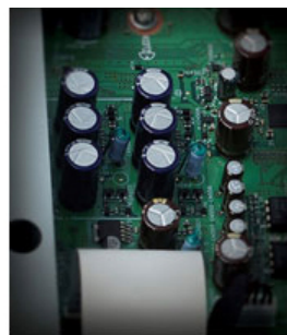
バッテリー用の大容量コンデンサー
