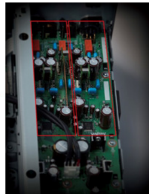
デュアルモノラル構成のD/A回路
