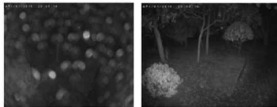
<親水コート無し> <親水コート有り> 親水コートによって、水滴による赤外線照明の反射を防ぎ、視界を確保
