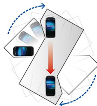
タンブルテストのイメージ。回転する実験装置の中で連続して1 m落下します。
