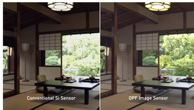
従来シリコンセンサ 有機センサ 図6. 8Kセンサ 広ダイナミックレンジ撮像例 和室撮影
