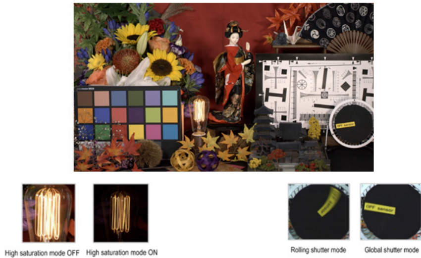
(a) 電球 [写真の中央部] 高感度モード [左] と高飽和モード [右] (b) 回転体 [写真の右下部] ローリングシャッター [左] とグローバルシャッター [右]
