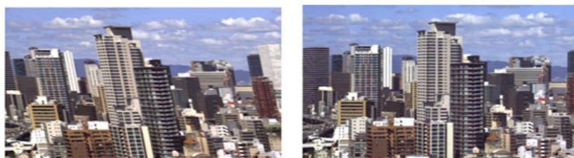
ローリングシャッター(有機センサ) グローバルシャッター(有機センサ) 図9. ローリングシャッターモードとグローバルシャッターモードの比較 高速パニング撮影
