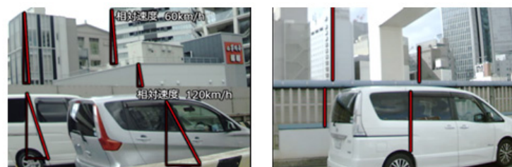
ローリングシャッタ グローバルシャッタ 図7. ローリングシャッタモードとグローバルシャッタモードの比較 高速道路走行撮影
