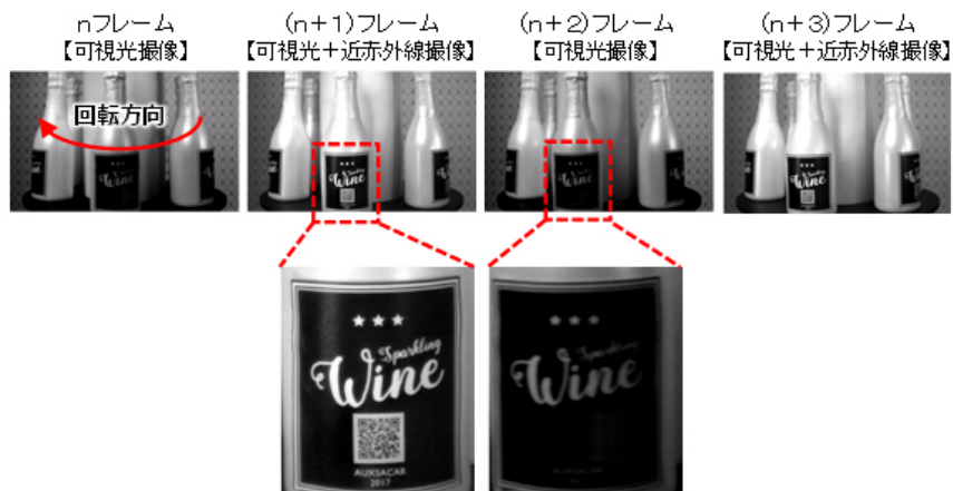
図4 回転するボトルをフレーム単位で撮像波長域を切り換えて撮像した画像事例 可視光域と近赤外線域とで見え方の異なるインクを用いてQRコードを印刷しているため、 近赤外線域の撮像時にのみQRコード認識が可能になる
