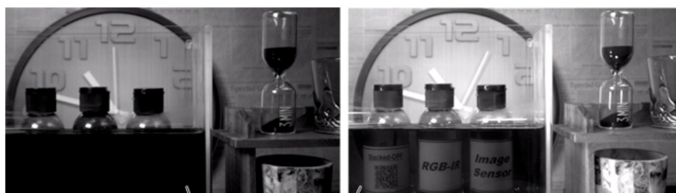
図3 可視光域のみで撮像した画面(左) 可視光域と近赤外線域で撮像した画面(右) 近赤外線域撮像では水槽の醤油が透けて、奥にある瓶のラベルが認識できる
