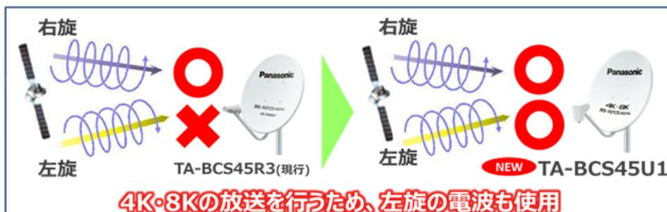
従来品のTA-BCS45R3では右旋の放送波しか受信できませんでしたが、新製品TA-BCS45U1であれば従来の右旋に加えて左旋の電波も受信できるため将来4K・8K放送が始まって、そのままご使用いただけます。
