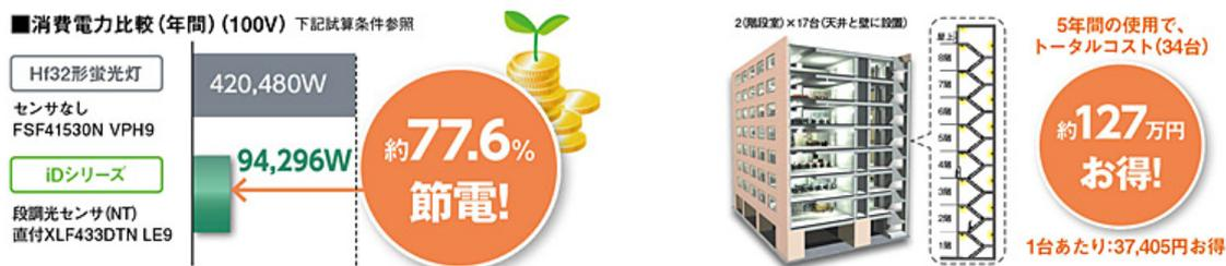
※5:計算式補足 不在時間1:土日の総時間1、不在時間2:月~金の大気消費電力センサ時間 不在日数:土日の年間日数 年間消費電力計算:【フル稼働時×センサ稼働時/年間】全灯時間/日×稼働日数×全灯時電力)+(不在時間1×不在日数+不在時間2×稼働日数)×待機電力 新電力料金目安単価:25円/kWh(税込)【家電公正取引協議会が発出した「新電力料金目安単価 27円/kWh(税込/一般家庭用)から消費税相当額8%を抜いた金額で算出
